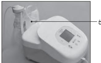
يمكن ضبط التفريغ والدورات بشكل مستقل عن بعضهم البعض. اختيار الضبط الأكثر راحة بالنسبة لكي.
